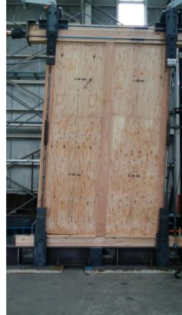
合板張り真壁耐力壁 高さ3.6m 幅2.00m
