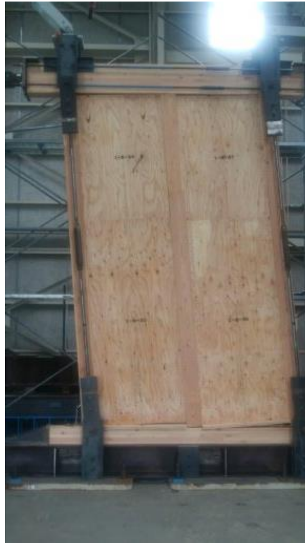
合板張り真壁耐力壁 高さ3.6m 幅2.00m
